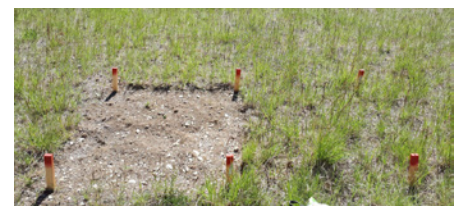
Versuchsaufbau: vegetationsfreie Parzelle (1m 2 , links) mit anliegender Kontrollfläche (rechts)
