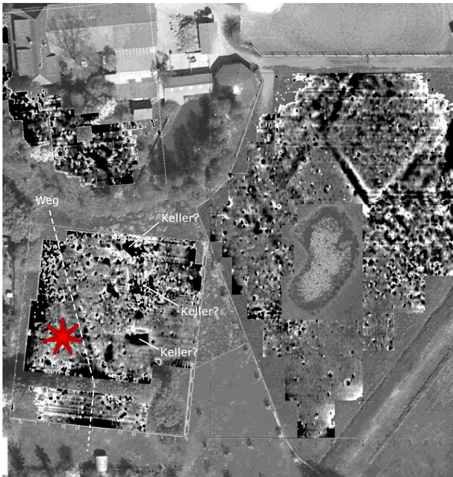
Abb. 7, Messbilder der Geomagnetik Grundstücke Ebeling und Schulz-Wallheinke; Messpunktabstand 0,50 x 0,10 m; nT-Werte zwischen -1403,92 bis 1007,02. Roter Stern = ungefähre Fundort von Abb. 7.
